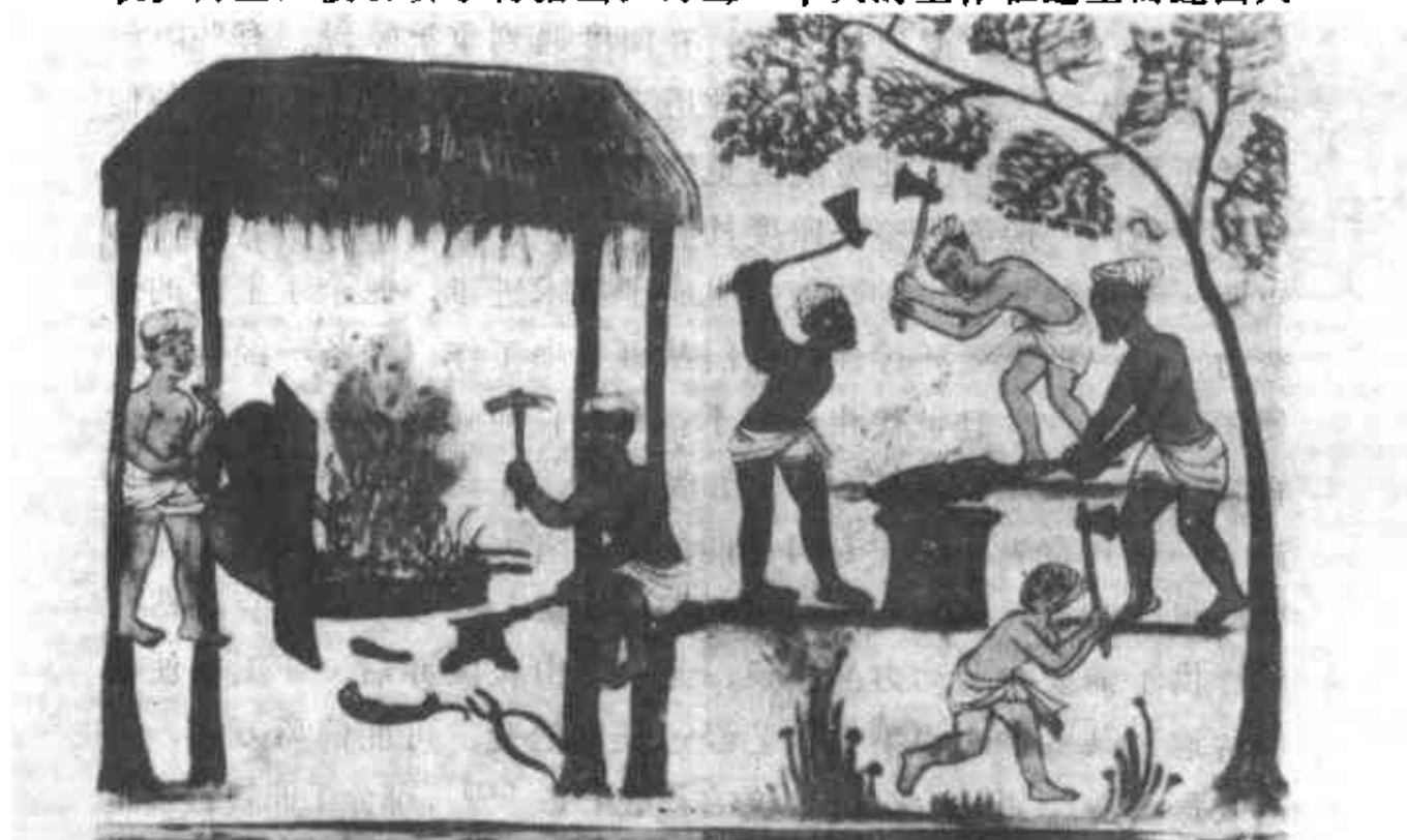
十六世纪果阿的土著铁匠：技术原始；手动风箱，形状奇特的铁锤大概兼作斧子之用。
